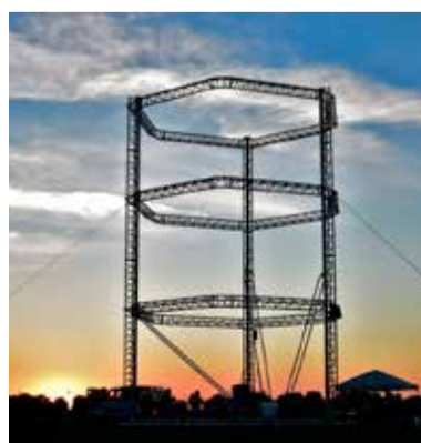
VERDENS STØRSTE 3D-printer måler 12 meter i højden og 6 meter i diameter. Foto: Wasp
